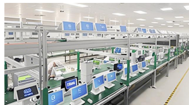
自动倍速链老化测试
